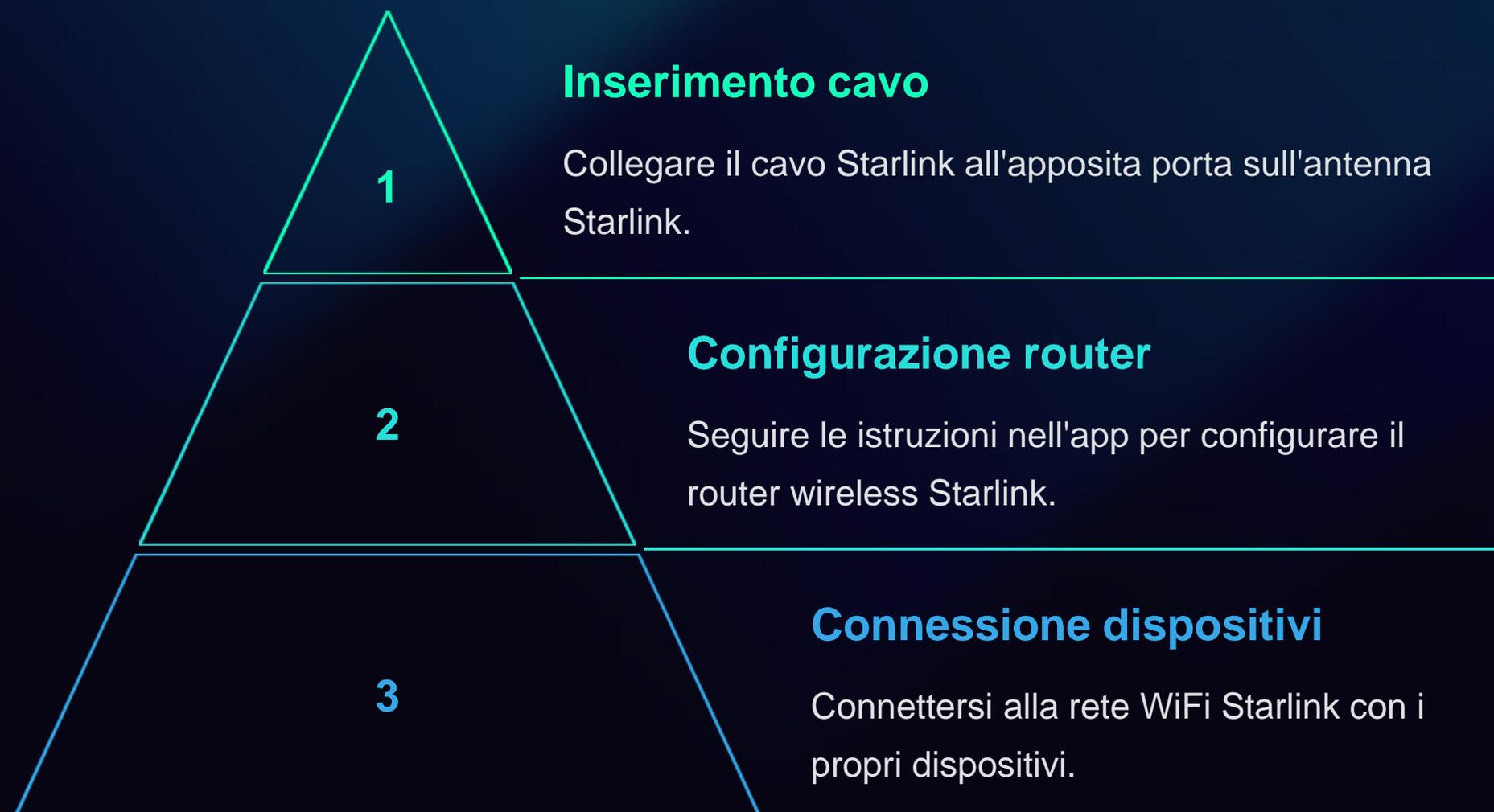
Una volta che l'antenna Starlink è correttamente alimentata e posizionata, è necessario collegare il cavo Starlink al router fornito. Attraverso l'applicazione Starlink, è possibile configurare il router Starlink ed il router personale tramite adattatore Ethernet e cavo RJ45.
